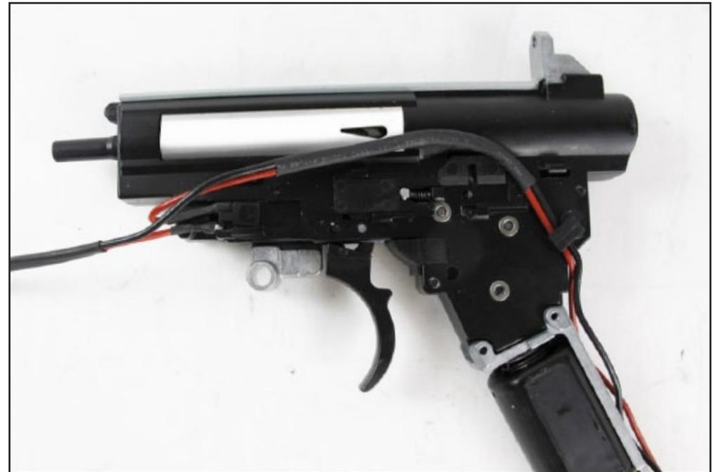
**19.****Conjunto del interruptor de baja resistencia y mini fusible**
